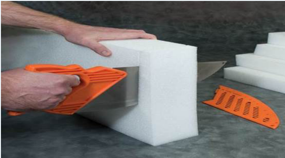
Ethafoam Polyplank kuttes lett med håndsag. Kniver med tannet skjær virker også bra.
